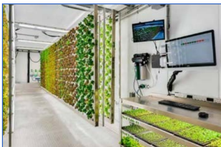
Obr. 10 – rastliny vo FarmBoxe sa pestujú vo zvislých závesných táckach, ktoré je možné pri údržbe a zberu posúvať zo strany na stranu
