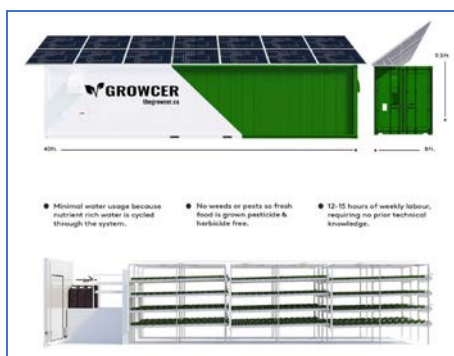
Obr. 8 – šikmé podnosy spoločnosti Growcer umožňujú neustály tok vody naplnenej živinami s cirkuláciou pod všetkými rastlinami
