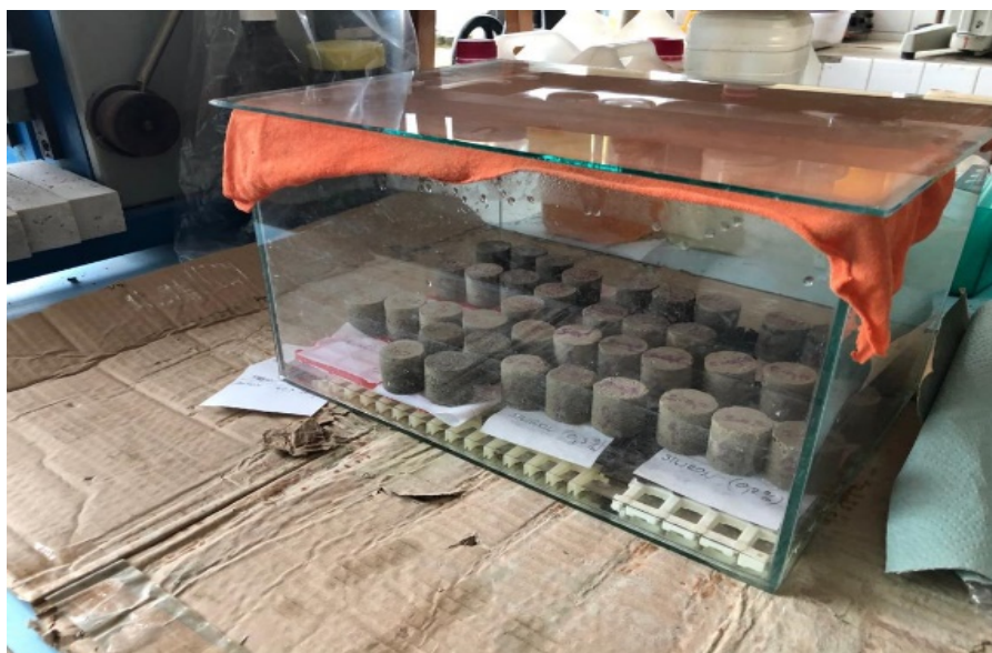
Obr. 5 - Hotové vzorky zmesi po odformovaní uložené vo vlhkom prostredí Zdroj: BUCH, 2019
