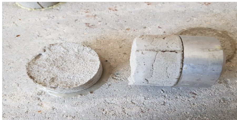
Na obr. 7 je možné vidieť vzorky po vykonanej odtrhovej skúške s oddelením hornej a spodnej vrstvy.
