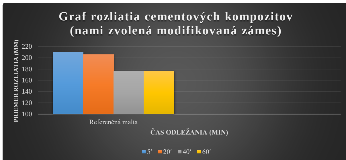
Graf 2 – Závislosť zmeny konzistencie od dávky kombinácie prísad Zdroj: BUCH, 2019
