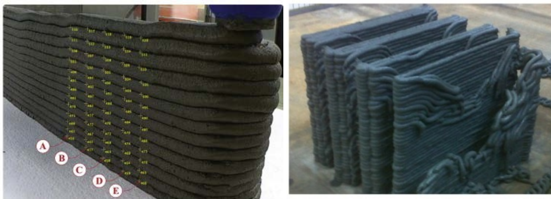
Obr.4– Zrútenie vytlačenej konštrukcie v dôsledku nedostatočného zatvrdnutia spodných vrstiev Zdroj: BUSWELL R.A. a W.R. LEAN DE SILVA, 2018
