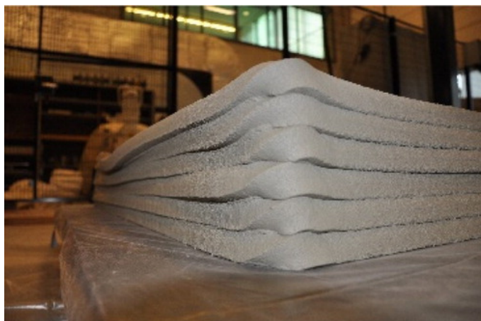
Obr.7– Rohy v 3D tlačenej konštrukcii Zdroj: ALTER L., 2015
