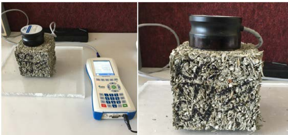
Obr. 2 – Meranie tepelno-technických vlastností skúšobnej vzorky prístrojom Isomet 2114 Zdroj: Autor
