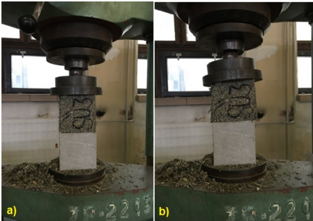
Obr. 4 – Pohľad na skúšobnú vzorku uloženú v hydraulickom lise: a) bez vývinu zaťaženia (sily); b) po zaťažení (pôsobení sily)
