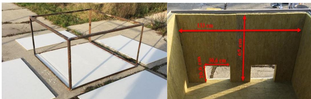
Obr. 2 – Konštrukcia modelu a vnútorné rozmery
