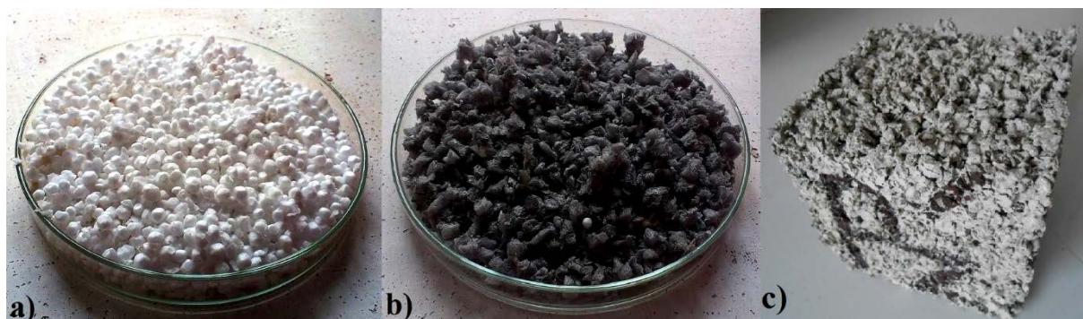
Obr. 1 – a) odpadový polystyrén, zrnitosť 4/8 mm; b) odpadový polypropylén, zrnitosť 4/8 mm; c) skúšobná vzorka ľahkého betónu (PZ: plnivo 100 % polypropylén)
